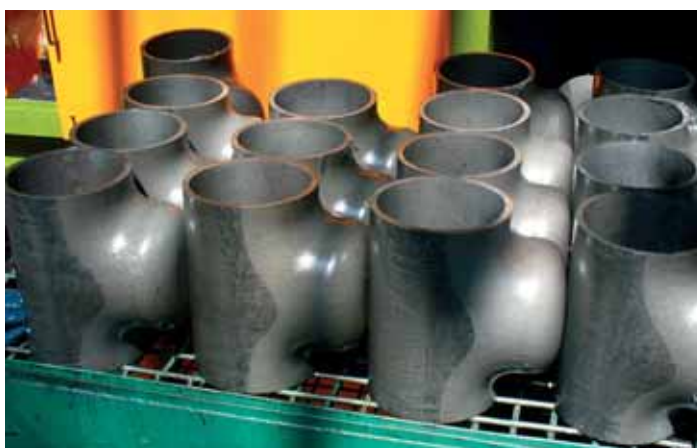
Рис 6. На фото - тройники, изготовленные по новой технологии и прошедшие механическую обработку. Легко заметить, что недостатки, свойственные деталям, изготовленным по старой технологии, отсутствуют.
