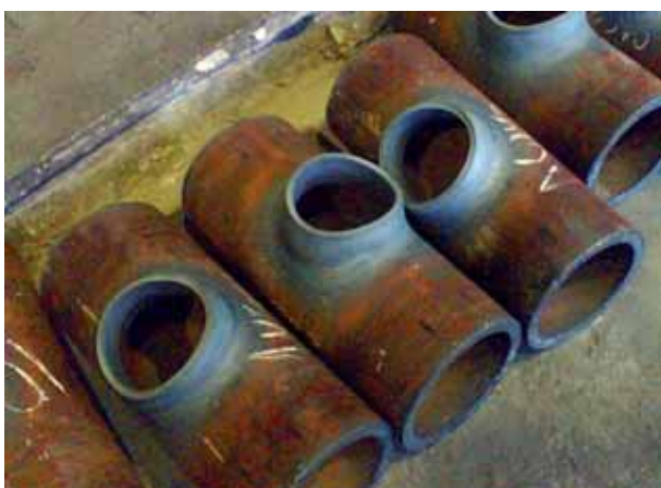
Рис 5. На фото представлены тройники, изготовленные по технологии, применявшейся на предприятии ранее. Отчетливо видны овальность, неровная поверхность, следы термического разогрева, утончение стенок на горловине по сравнению с исходной толщиной трубы.
