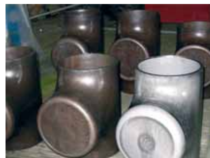
Рис 4. Готовая продукция - тройники изготовлены методом гидроформовки на прессы WETORY IST-1200
