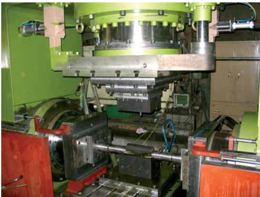
Рис 3. Рабочая зона прессы с установленным штампом
