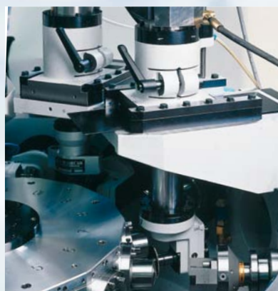
Вертикальный суппорт для установки вертикальных обрабатывающих узлов
