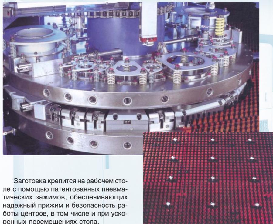
Заготовка крепится на рабочем столе с помощью патентованных пневматических зажимов, обеспечивающих надежный прижим и безопасность работы центров, в том числе и при ускоренных перемещениях стола.
