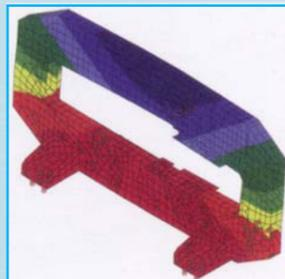
ботке. Это, в свою очередь, обеспечивает высокое качество работы пресса (благодаря постоянному зазору между матрицей и пуансоном) и длительный срок службы инструмента. Для оптимизации статических и динамических характеристик центров при их проектировании использовался анализ по методу конечных элементов (МКЭ).
