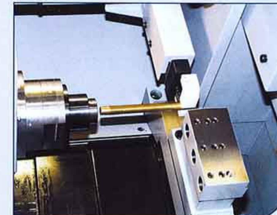
Устройство разгрузки деталей U35J
