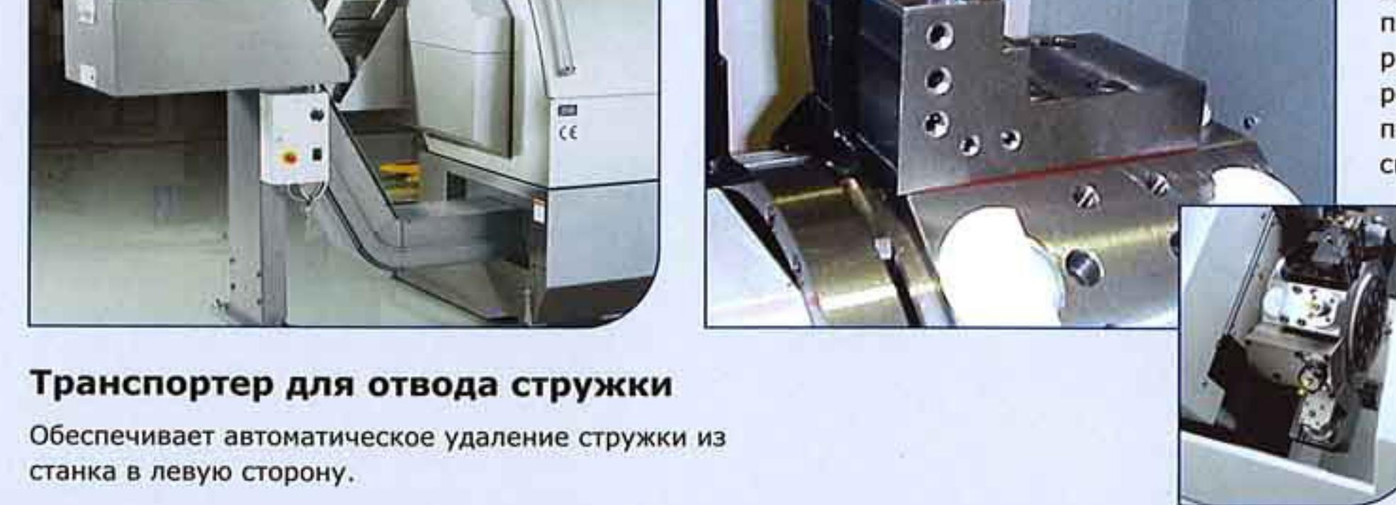
Транспортер для отвода стружки
