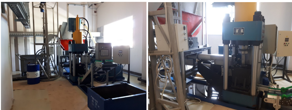
Рис. 2. Реализованная в АО «Позис» линия брикетирования стружки
