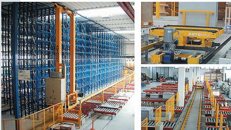
Рис. 9. Система автоматического складирования и межоперационной транспортировки
